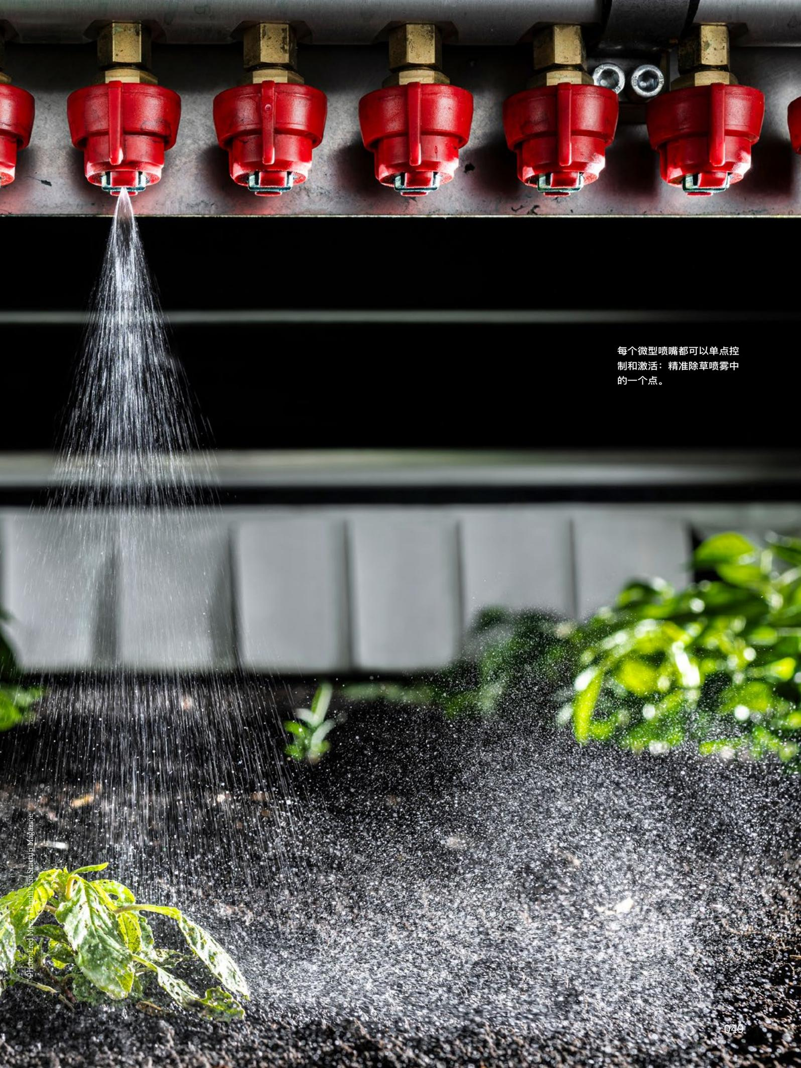
每个微型喷嘴都可以单点控制和激活：精准除草喷雾中的一个点。
