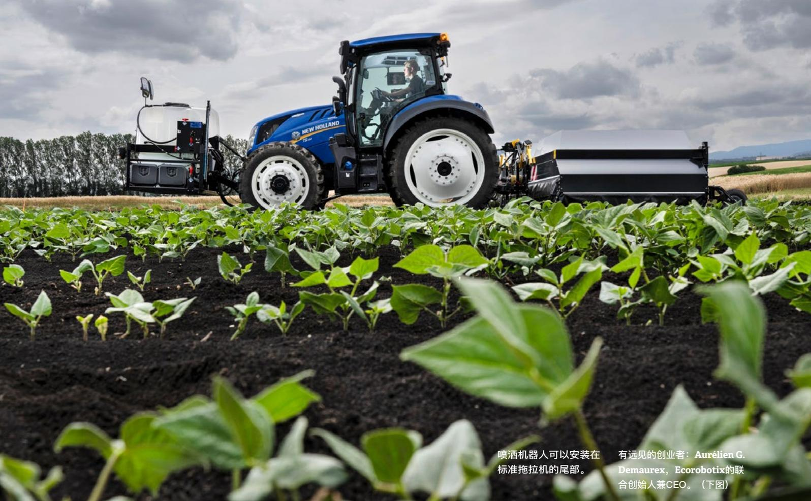
喷洒机器人可以安装在标准拖拉机的尾部。
